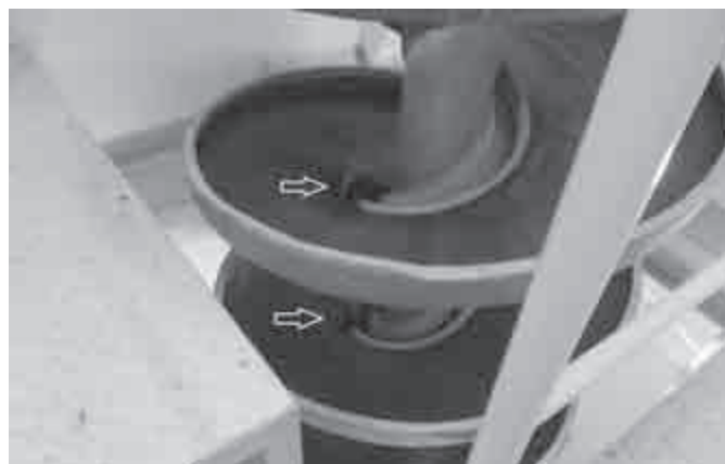
Obrázek 11. Proudění rmutu na spirále a nastavení stíracích klapek pro písčitou frakci
