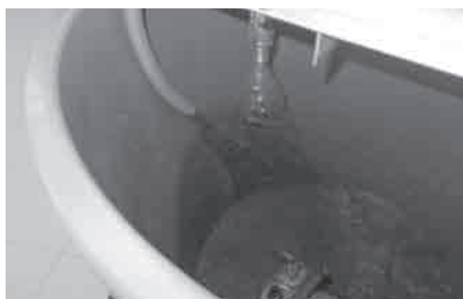
Obrázek 13. Spodek hydrocyklonu a dva výstupy rozduřování sedimentu
