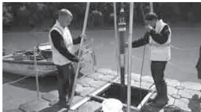
Obrázek 3. Kompletně složené odběrné zařízení
