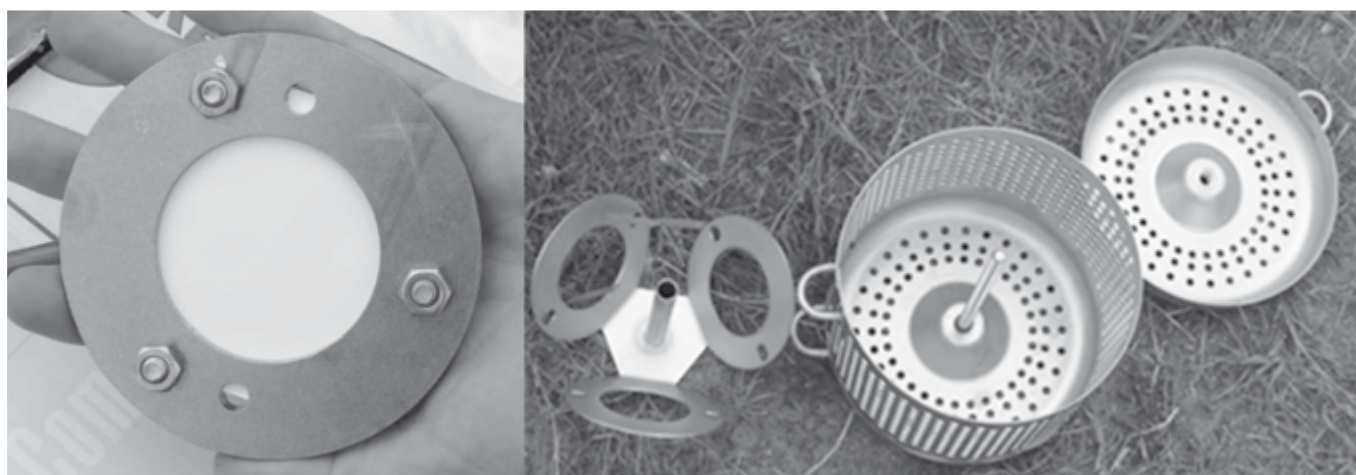
Obrázek 1. Pasivní vzorkovač POCIS a ochranný koš
