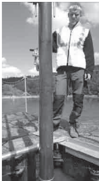
Obrázek 3. Kompletně složené odběrné zařízení
