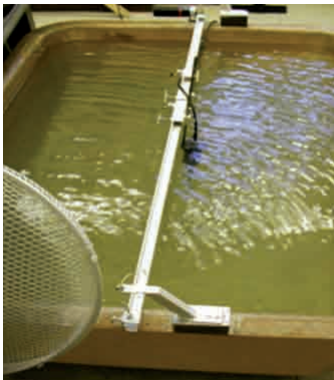
Obrázek 1. Laboratorní výzkum vlivu rychlosti větru na prokysličení
