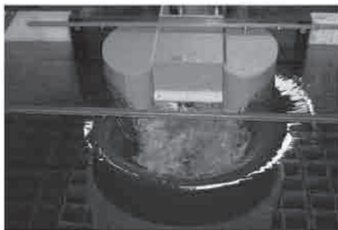
Obrázek 3. Porovnání tvarů hladin zjištěných při matematickém a fyzikálním modelování – pohled do spadiště při průtoku Q_{100} [3]
