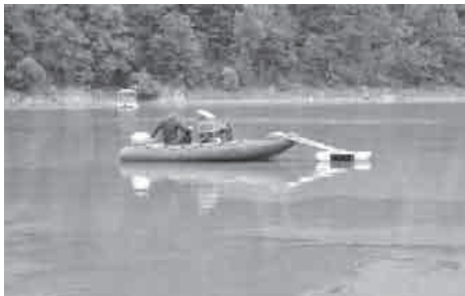
Obrázek 5. Plavidlo vybavené zařízením pro lokalizaci sedimentů, strukturu sedimentů, se sběrem dat pro tvorbu bathygrafických map
