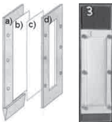
Obrázek 2. Schéma dílčích částí minipeeperu: a) plexisklová destička tvořící nosnou část, b) funkční část – proužek gelu, c) propustná membrána (porozita 0,4 \mu\text{m} ) chránící gel, d) plexisklový rámeček, který drží pomocí šroubů všechny části pohromadě. V druhé části fotografie sestaveného minipeeperu
