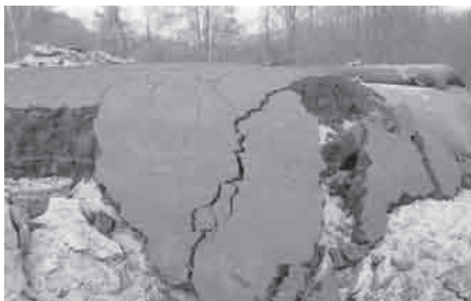
Obrázek 8. Oddělení frakce jílu se zeminou od písku
