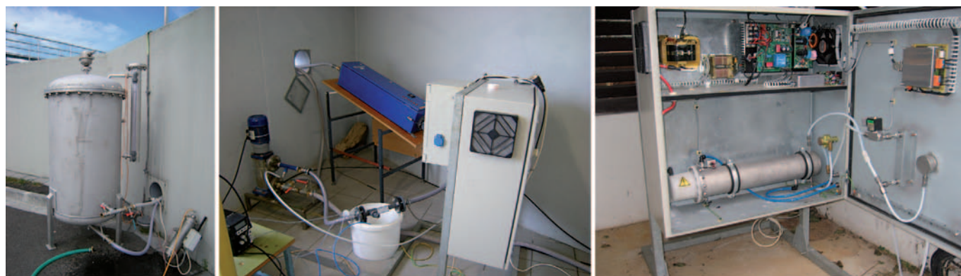
Obrázek 1. Pilotní ozonizační jednotka.
