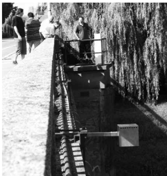
Obr. 6. – Ultrazvukové čidlo na mostě přes odlehčovací rameno
