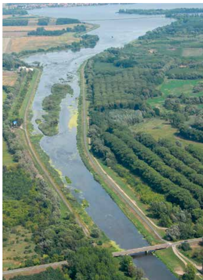
Obrázek 1. Zarůstající nánosy v horní části HN VD NM mezi mostem Brod nad Dyjí a mostem Drnholec (PM, 2015)
