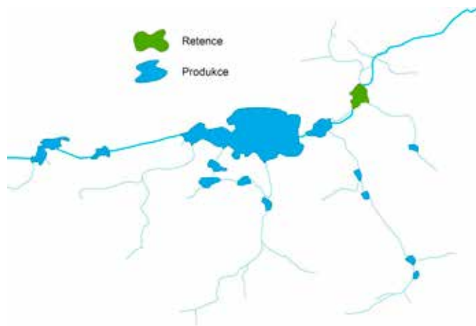
Obrázek 3. Schématické znázornění principu retenční nádrže pro omezení odnosu živin z nadřazeného povodí
